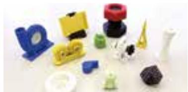
◆ 3DCADから3Dプリンターで試作します。
